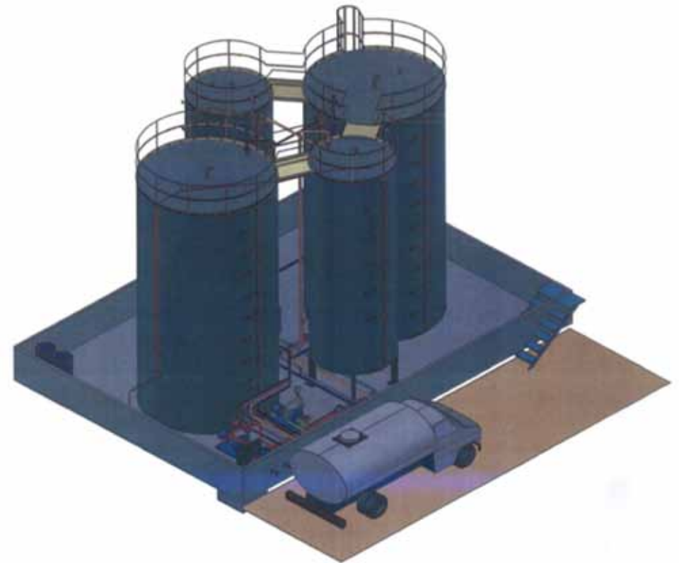
Exemple de centre de transit d'une capacité de stockage d'huiles usagées de 260 m 3
