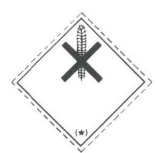
Classe 6 - Division 6.1 Groupe de danger III La moitié inférieure de l'étiquette doit porter la mention : Nocif - A tenir éloigné des denrées alimentaires
