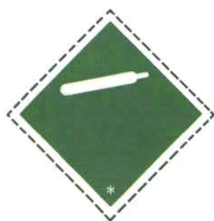
Gaz non inflammables Signe conventionnel (bouteille de gaz) en noir ou blanc, fond vert
