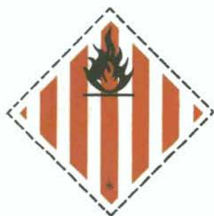
Division 4.1 Solides inflammables Signe conventionnel (flamme) : en noir Fond : blanc avec des bandes verticales rouges
