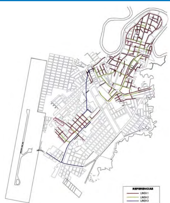
Figura 16: Red de energía eléctrica de Cobija.
