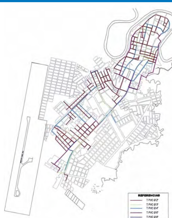
Figura 15: Mapa del sistema de abastecimiento de agua potable existentes en la zona urbana de Cobija.
