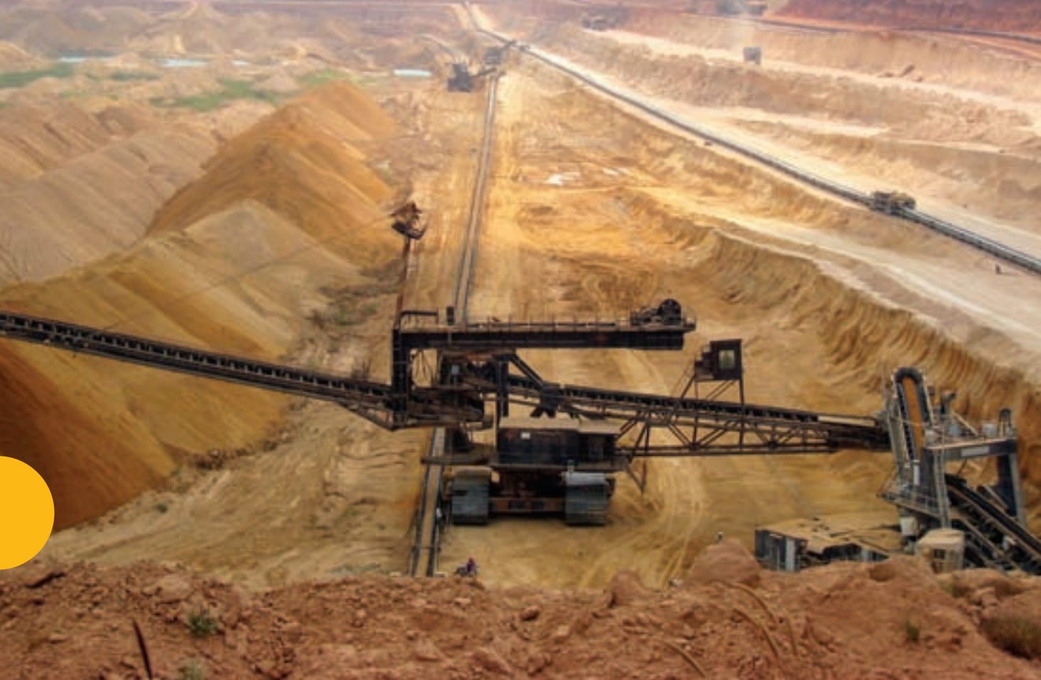
Mine de phosphate à ciel ouvert au Togo. La plupart du phosphate naturel dans le monde est extrait de mines à ciel ouvert, comme celle illustrée ici, ou de mines à grande échelle équipées de draglines et de pelles mécaniques ou d'excavatrices. Photo : Alexandra Pugachevsky
