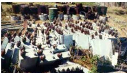
Photo 84 : Mauvais exemple I (entreposage à ciel ouvert)
