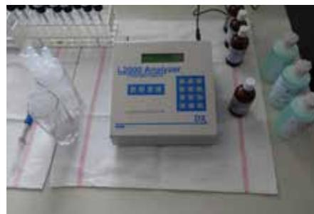
Photo 27 : Analyseur L2000 pour PCB
