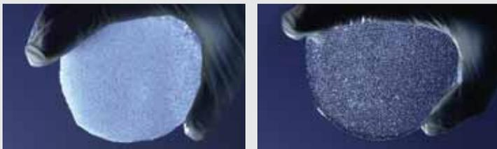
À gauche : un morceau de carotte de glace peu profonde à travers lequel l'air circule librement. À droite : un morceau prélevé à une profondeur de 120 mètres, dans laquelle les bulles d'air emprisonnées sont clairement visibles. Ci-dessous : les scientifiques de l'Antarctique détachent d'une foreuse une carotte de glace vieille de 10 000 ans.
