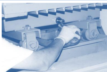
Prélever l'échantillon d'huile (30-50ml pour le dépistage de PCB, 1l si la qualité de l'huile est également analysée)
