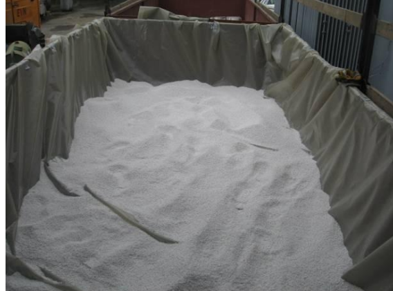
Photo 70 : Matériau absorbant inerte placé au fond de l'unité
