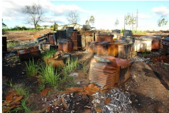
Photo 52 : Restes de transformateurs dans un dépôt de ferraille
