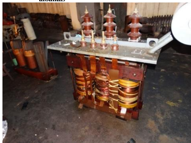
Photo 41 : Pièce de transformateur active dans un atelier albanais
