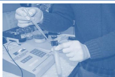
Analyser l'échantillon d'huile par Clor-N-Oil ou analyseur L2000 DX
