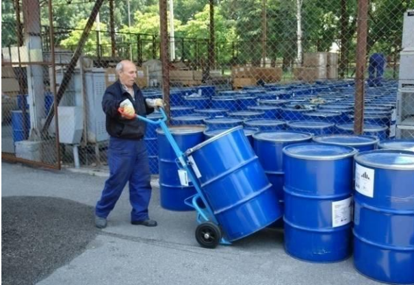
Photo 82 : Diable de manutention pour le déplacement des fûts en toute sécurité
