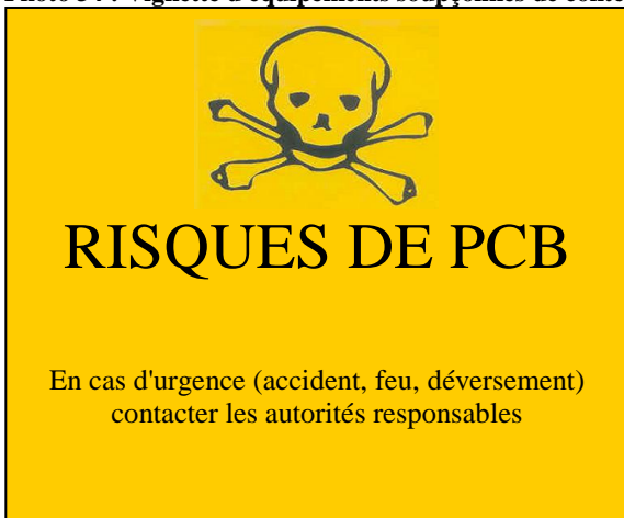
Photo 34 : Vignette d'équipements soupçonnés de contenir des PCB
