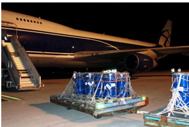
Photo 101 : Déchets contenant des PCB prêts à être transportés par voie aérienne
