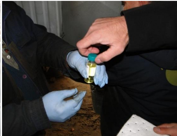
Photo 10 : Étiquetage AVANT le prélèvement
