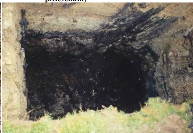
Photo 22 : Échantillonnage de profondeur (sillon de prélèvement)
