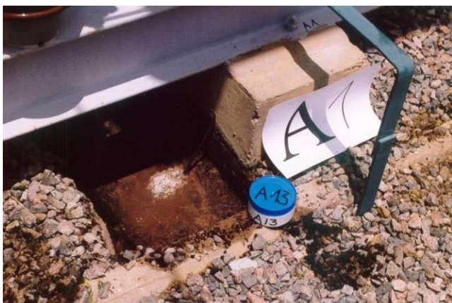
Photo 21 : Échantillonnage de surface
