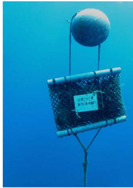
Schéma 1 : structure du mouillage RINBIO Photo 1 : poche RINBIO et nokalon supérieur
