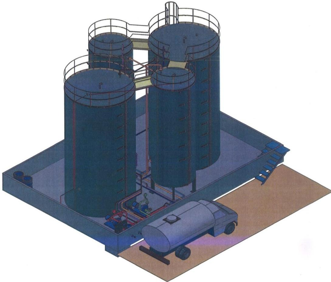
Exemple de centre de transit d'une capacité de stockage d'huiles usagées de 260 m<sup>3</sup>.
