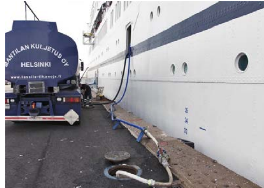
Collecte d'eaux usées dans le port d'Helsinki (Finlande) (Crédits photographiques : Clean Baltic Sea Shipping)
