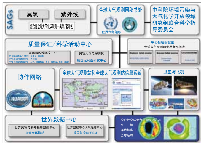
图1 世界气象组织/全球大气观测网臭氧监测系统构成，包括协作网络：大气构成变化探测网（原先的平流层变化监测网络）和南半球额外臭氧探空仪网络。SAG=科学咨询小组，RCC=区域标校中心，WCC=国际标校中心。
