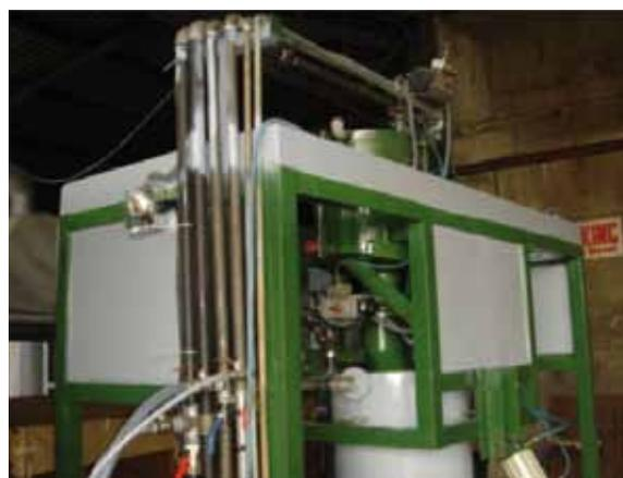
**Machine à mousse conçue et fabriquée localement par Pamaque Nig. Ltd.**
