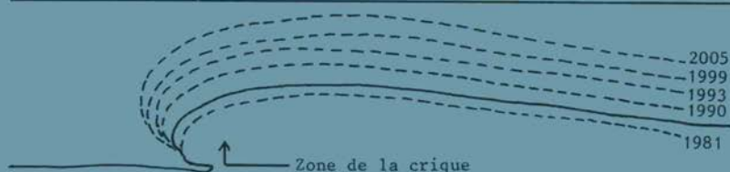
Evolution du littoral à l'est du port de Cotonou sans travaux de protection jusqu'en l'an 2005 (d'après NEDECO).
