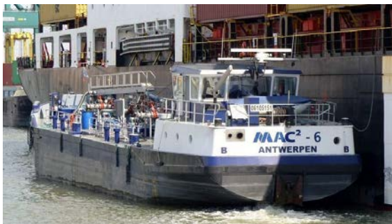
Barge de collecte des résidus liquides contenant des hydrocarbures (Crédits photographiques : MAC 2 Anvers, Belgique)
