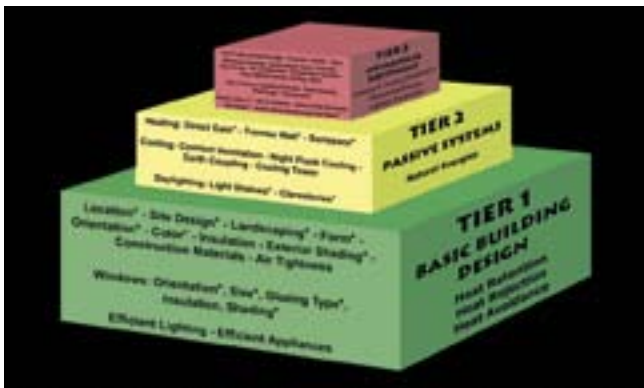
Three tier approach to sustainable heating, cooling and lighting of buildings Трёхуровневый подход к самодостаточному отоплению, охлаждению и освещению зданий
