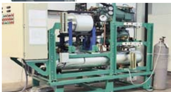
Pilot hydrofluorocarbons / carbon dioxide cascade system Экспериментальная каскадная система на основе гидрофторуглеродов и двуоксида углерода
