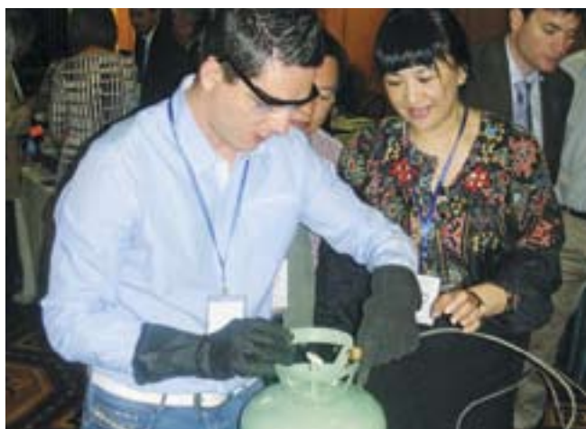
Mr. Igor Jakupic practicing the use of refrigerant identifiers in Ashgabat Игорь Якупич практикуется в применении идентификаторов хладагента в Ашхабаде
