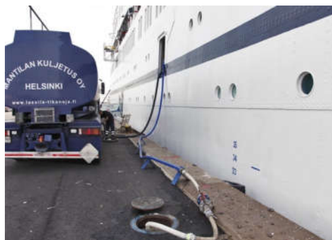
Collecte d'eaux usées dans le port d'Helsinki (Finlande) (Crédits photographiques : Clean Baltic Sea Shipping)
