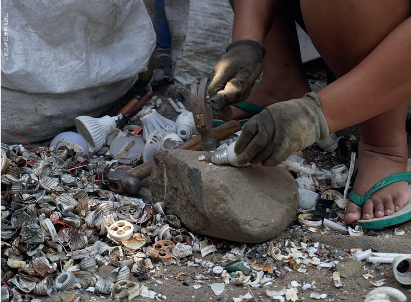
埋立地から回収された蛍光灯 を破壊してアルミニウムと銅を 再生資源として回収
