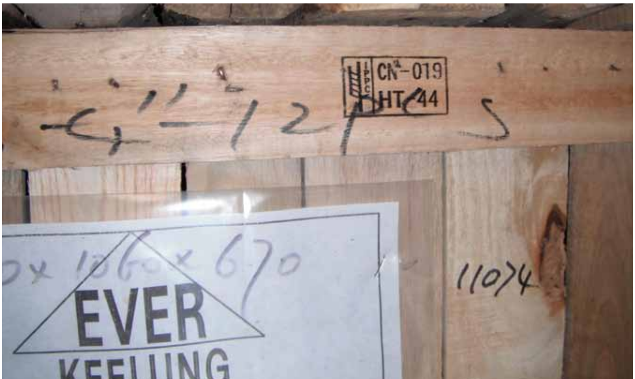
Embalajes de madera de China donde se observa el sello requerido por la CIPP que verifica el tratamiento con calor, en cumplimiento con la NIMF-15
