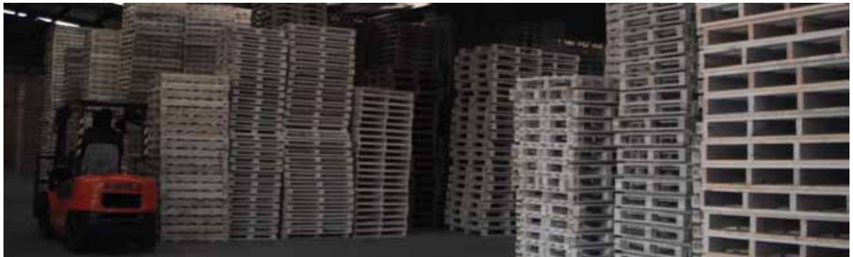
Los embalajes de madera en los que se empaquetan productos de exportación deben ser tratados para cumplir con la NIMF-15. En la actualidad, los tratamientos aprobados por la CIPP son el bromuro de metilo y el calor
