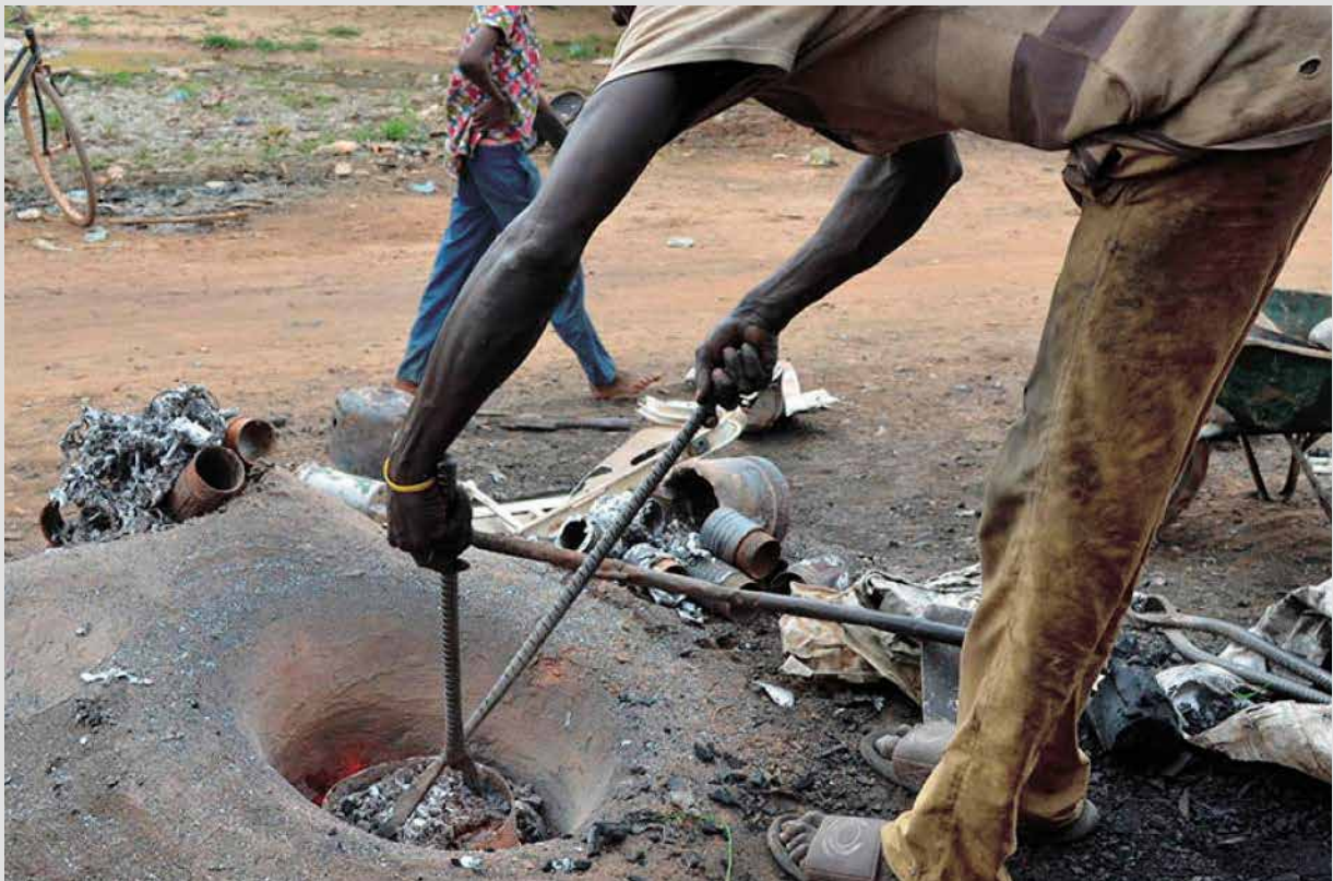
Recyclage informel de plomb de batteries au plomb usagées
