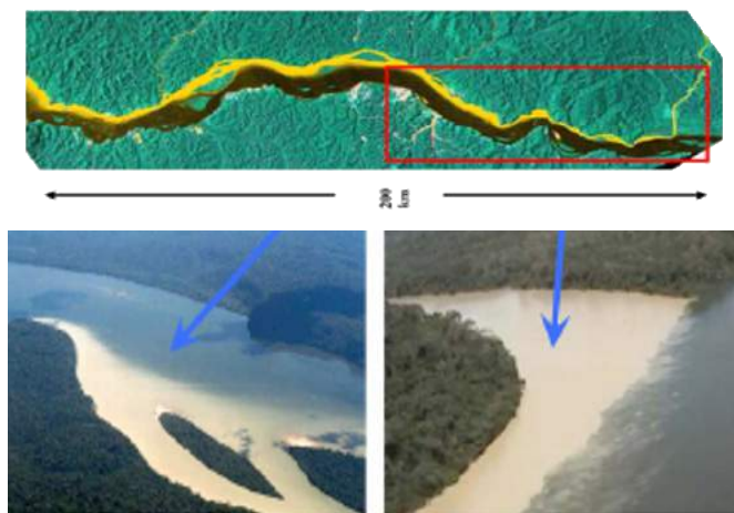
Figura 1-4. La imagen satelital Landsat con color falso muestra la sedimentación causada por la MAPE ubicada en un afluente tributario del río Tapajas, uno de los ríos tributarios más grandes del río Amazonas.
