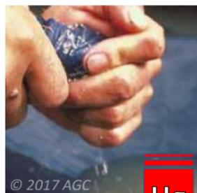
**Pressage de l'amalgame (Étape 6)** : Du mercure est rejeté dans la terre et dans les eaux de surface lorsqu'une partie du mercure pressé se répand sur le sol ou dans l'eau des résidus. Une autre partie est volontairement rejetée par les mineurs s'ils pensent qu'il est trop sale pour capturer l'or. Lors de la détermination des quantités de mercure rejetées, ces rejets volontaires doivent être pris en compte.
