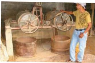
Pour les mines de roche dure, les étapes habituelles de traitement impliquent le concassage, le broyage et la concentration (le plus souvent à la batée ou avec un tapis de sluice). Le mercure peut être ajouté au stade du broyage (amalgamation du minerai brut) ou de la concentration (amalgamation du minerai concentré) pour capturer l'or dans un amalgame.
