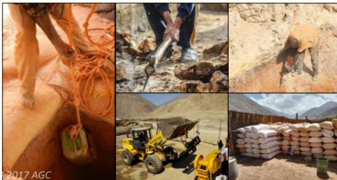
Sur les sites de roches tendres, les sédiments alluviaux peuvent être extraits avec des pelles, des godets, des excavatrices ou des jets d'eau (extraction hydraulique).
