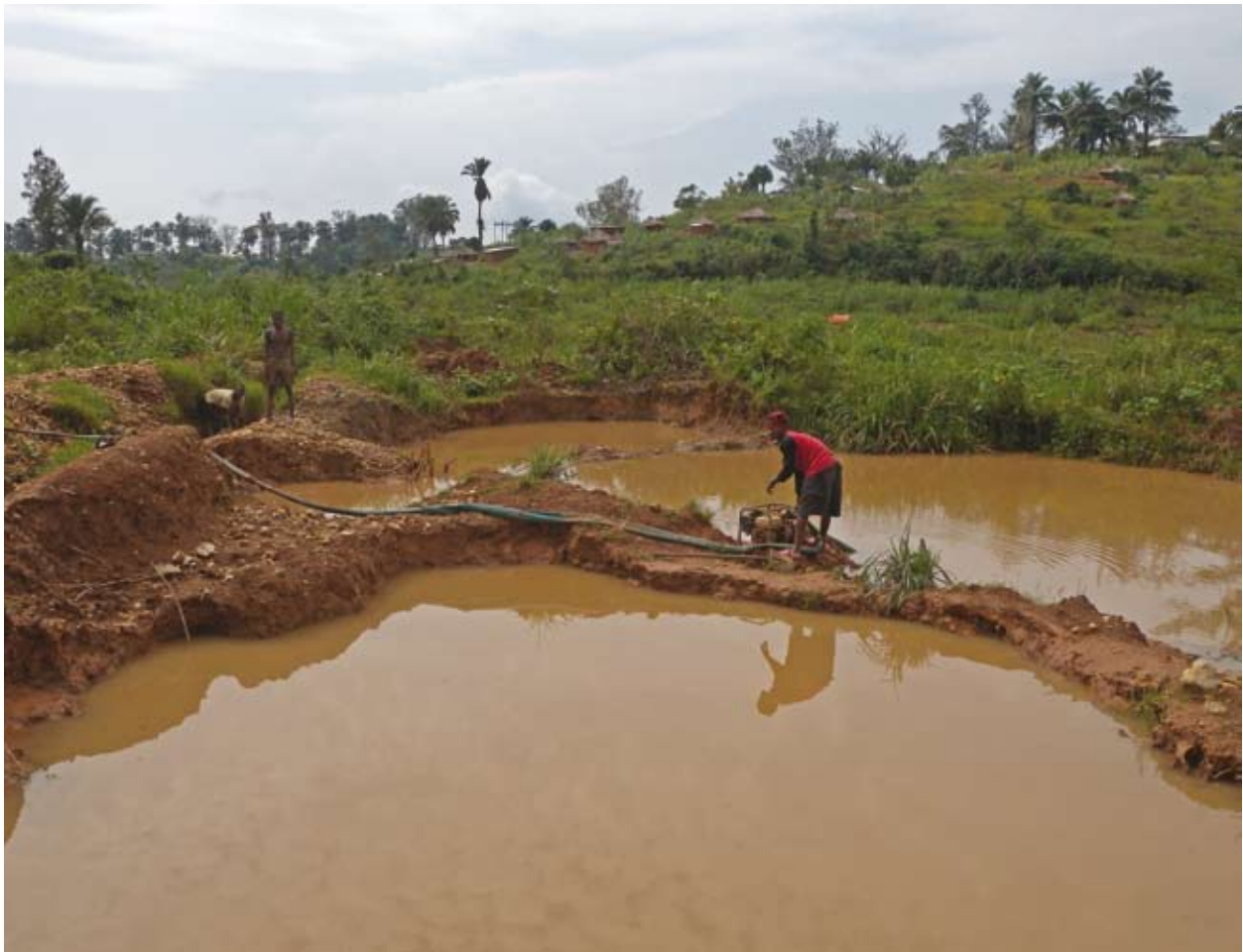
Les pompes à eau utilisées par les orpailleurs pour liquéfier la terre rejettent de grandes quantités de sédiments dans les cours d'eau et les lacs. Mongbwalu, district d'Ituri
