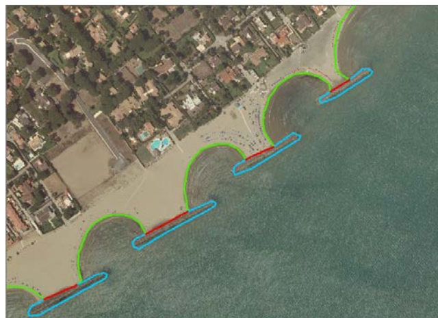
Figure 2. Image de structure de protection côtière (bleu), zone artificialisée (rouge) et côte naturelle (vert) (image fournie par G.Giorgi)
