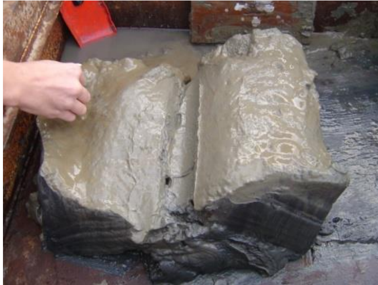
Figure 1 : Échantillon de sédiments boueux prélevé à l'aide d'une grande benne preneuse. La couche supérieure de 1 cm est collectée pour des analyses de pollution chimique. L'on peut clairement distinguer les couches oxiques et anoxiques, Image fournie : Mudsedimentsample_CGuitart.jpg
