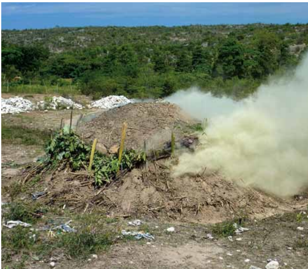
El carbón se produce en hornos que secan la madera y la convierten en carbón. Este horno está ubicado en la parte baja de la cuenca del Pedernales.
