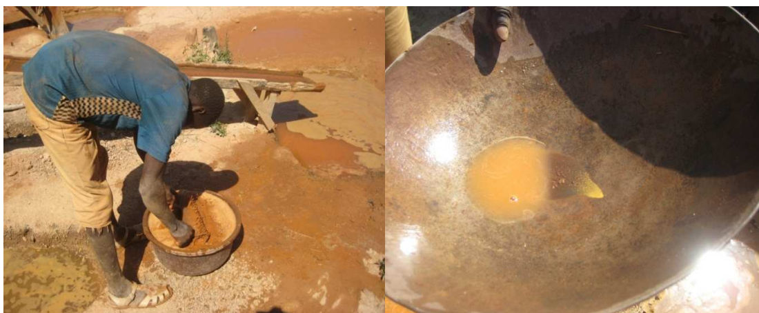
Technique de lavage pour la récupération d'or
